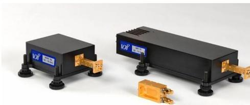
Ces modules sont intégrés dans les chaînes électroniques des différents scanners et de la base compacte pour faire des mesures entre 110 et 260 GHz.
